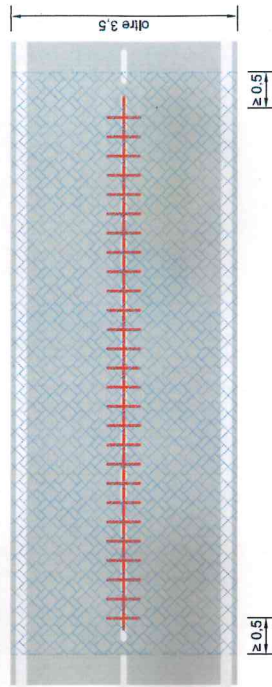
FIGURA 14 - scavo al centro della strada
